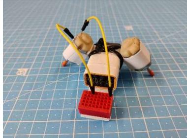
Gelbe Drähte wie am Bild am Motor befestigen und in Breadboard stecken
