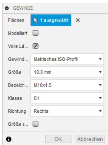
Abbildung 154 Feineinstellung für Gewinde
