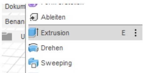
Abbildung 6 Untermenü ERSTELLEN mit Tastaturkürzel E für Extrusion ersichtlich
