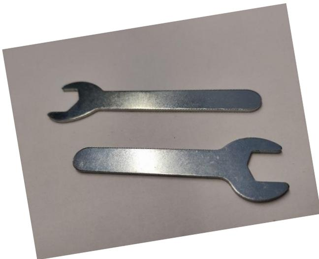
Gabelschlüssel zum Tauschen des Fräsers bzw. Gravierstichels
