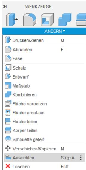
Durch das Werkzeug Ausrichten lassen sich Objekte miteinander ausrichten.
