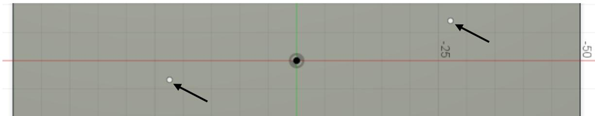
Für die genaue Positionierung wird das Werkzeug Skizzenbemaßung benötigt. Dieses ist in der Werkzeughauptleiste zu finden.
