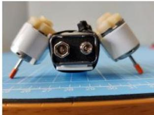
Die Motorhalterung leicht biegen, bis die Grundplatte nicht mehr komplett aufliegt
