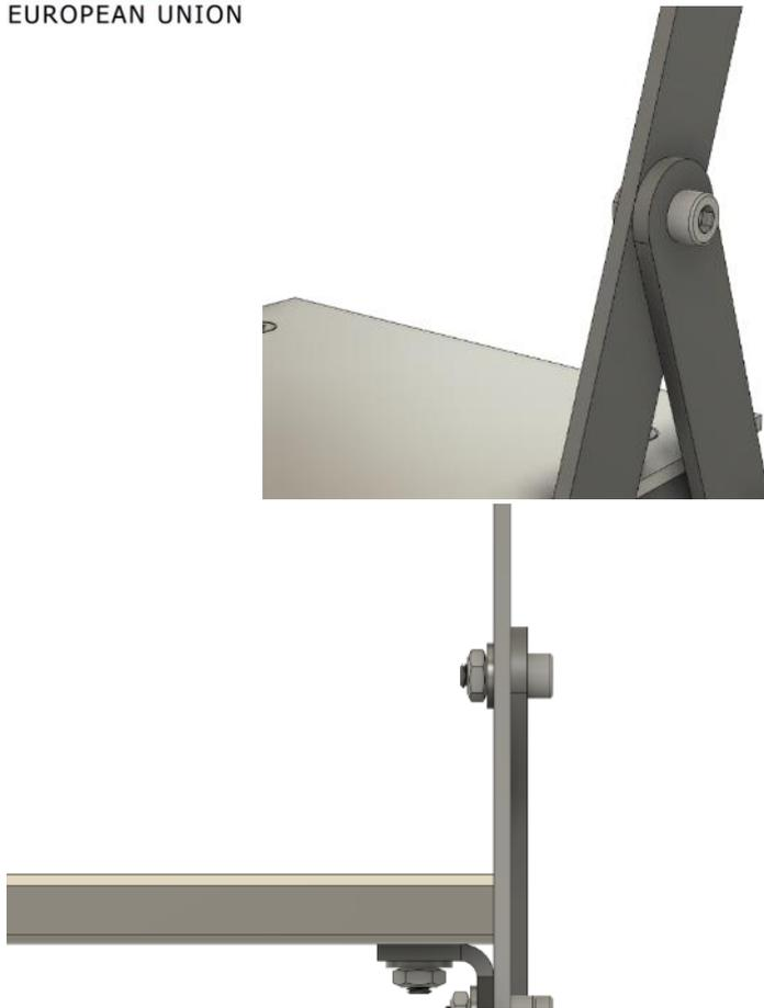
**Lehne oben an den langen Teilen anschrauben**
