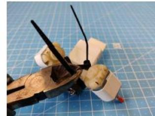
Überstehende Teile mit Seitenschneider entfernen
